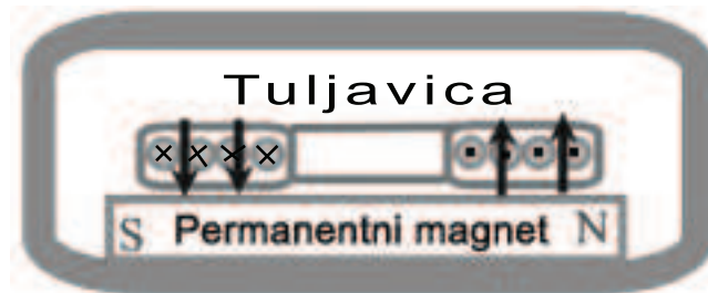
Slika 4.3: Tuljavica nad permanentnim magnetom, v ohišju.
